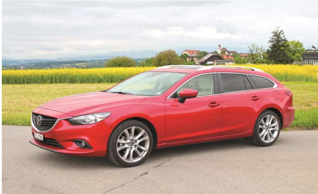
DIE DRITTE GENERATION DES MAZDA 6 IST SERIENMÄSSIG MIT EINER GANZEN ARMADA VON SICHERHEITS-ASSISTENZSYSTEMEN AUSGERÜSTET. ZUR VERBRAUCHSREDUZIERUNG ENTWICKELTE MAZDA EIN INNOVATIVES BREMSENERGIE-RÜCKGEWINNUNGSSYSTEM MIT KONDENSATOR-TECHNOLOGIE, DIE AUCH IN DER FORMEL 1 UNTER DEM NAMEN «KERS» BEKANNT IST.
