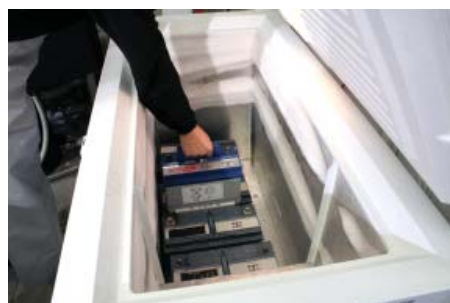
Vorbereitung für den Kaltstarttest.
